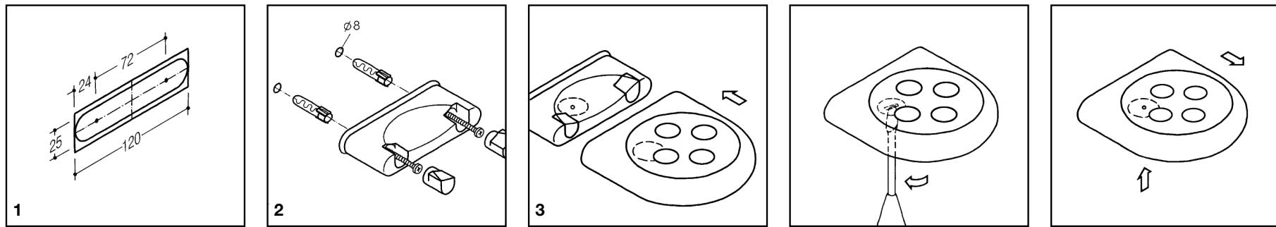
**D** Anreißschablone an Mittellinie ausrichten. Bohrpunkte anzeichnen.
